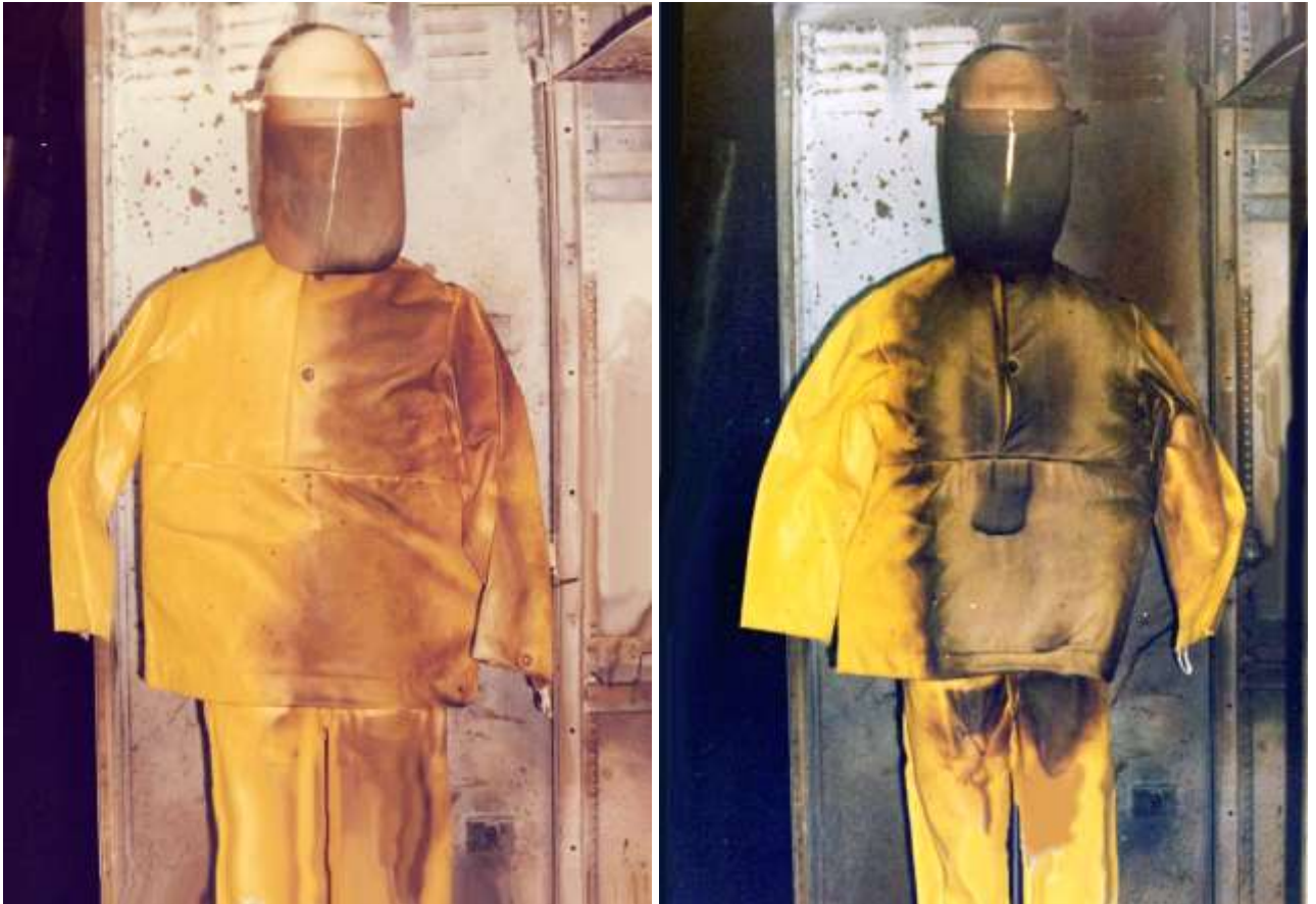
Bild 10: Ausrüstung der Kategorie 2, Belastung mit 650 V, 2,0 kA, 2 s
