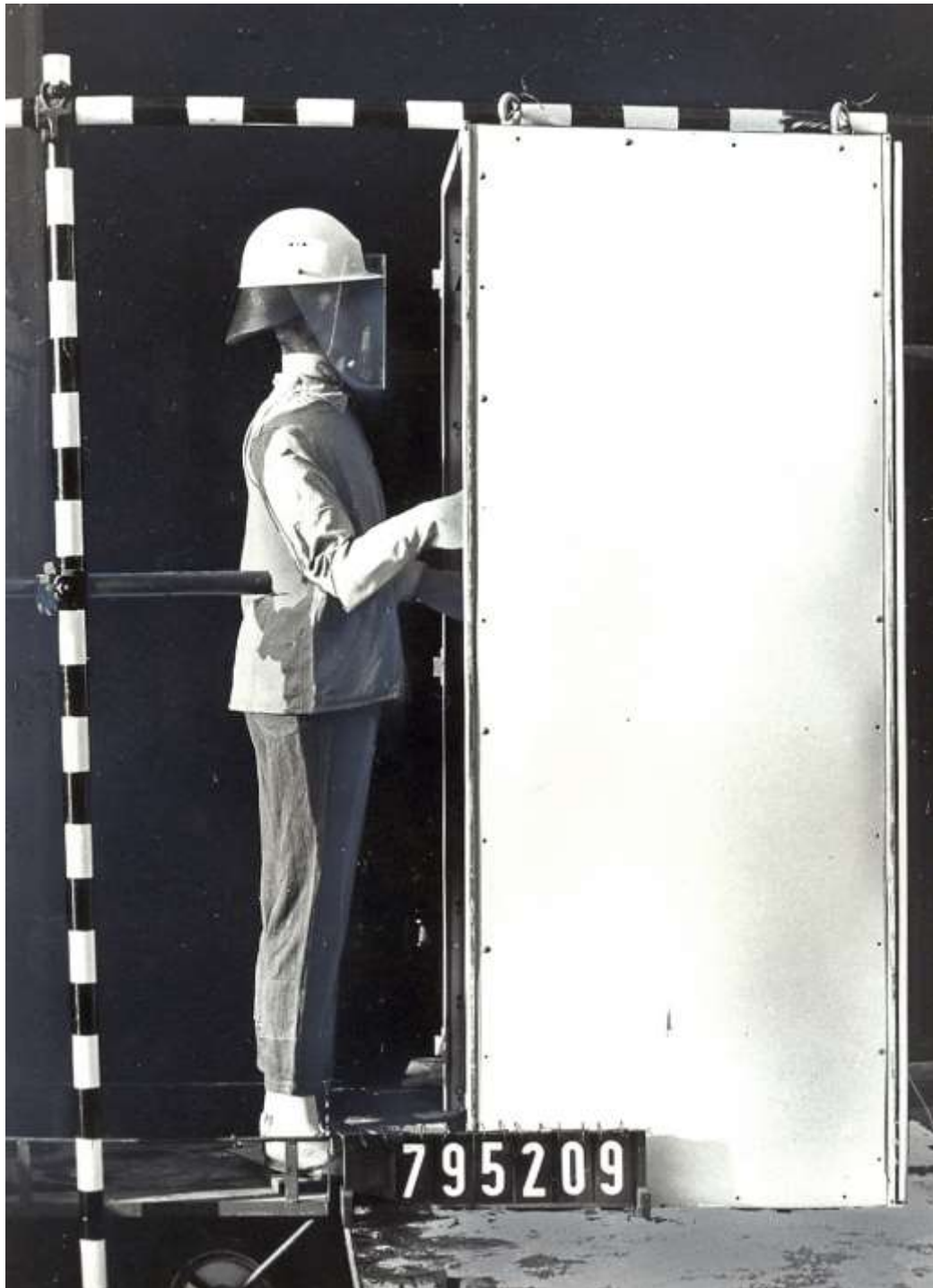
Bild 2: Versuchsanordnung mit Schaltfeld-Phantom und Versuchspuppe.
