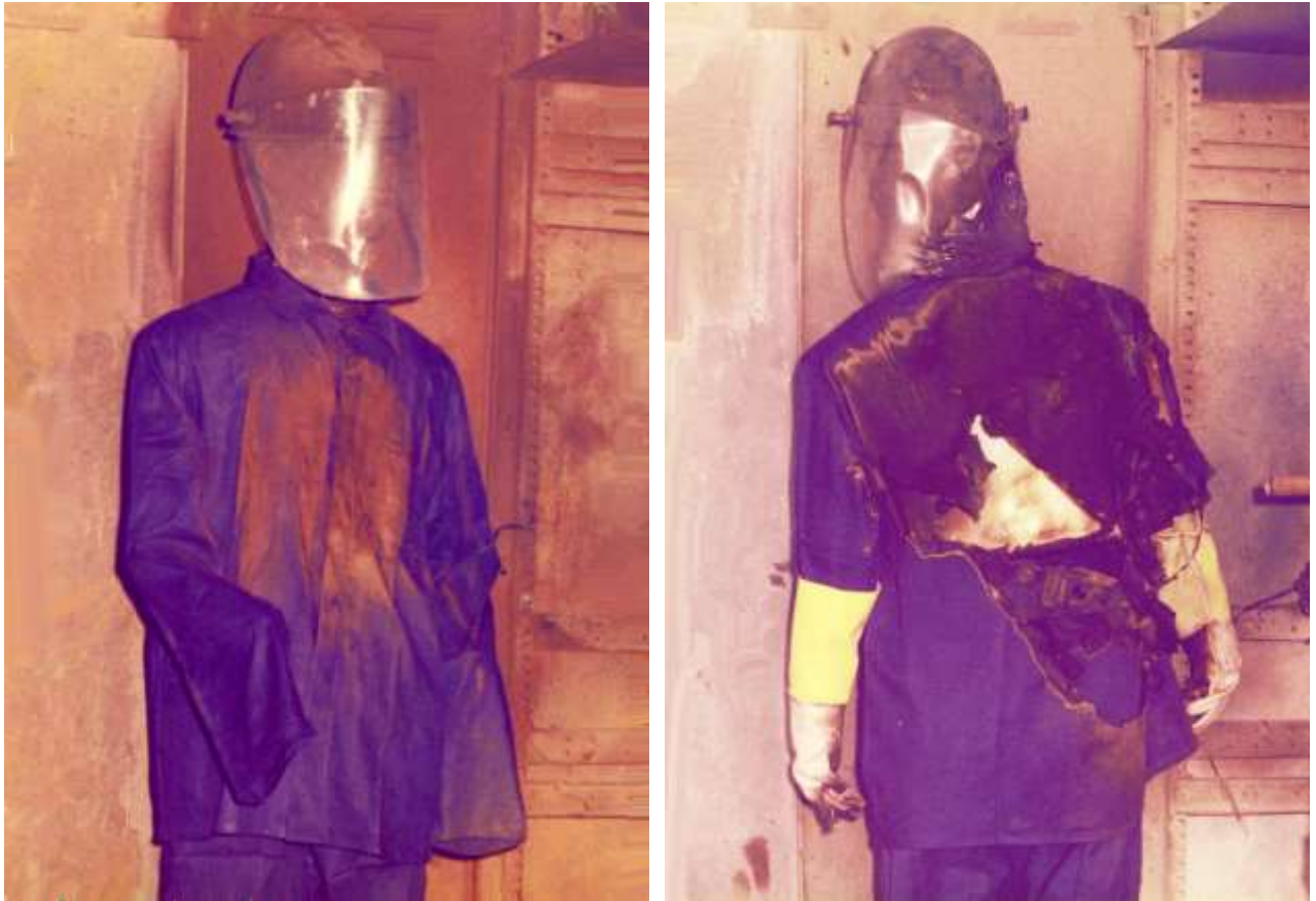
Bild 7: Ausrüstung der Kategorie 1 Belastung 580 V, 3,3 kA, 400 ms
