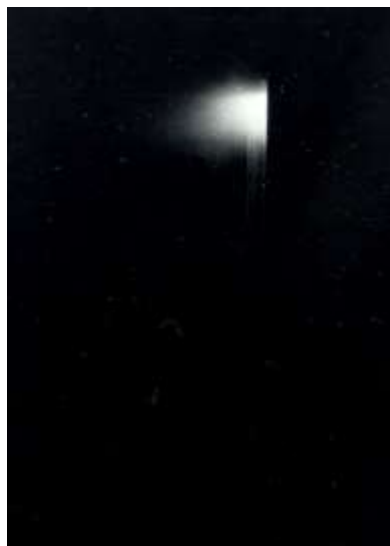
Bild 4: Silhouette der Lichtbogenbeanspruchung mit 10 kA, 380 V, 55 ms
