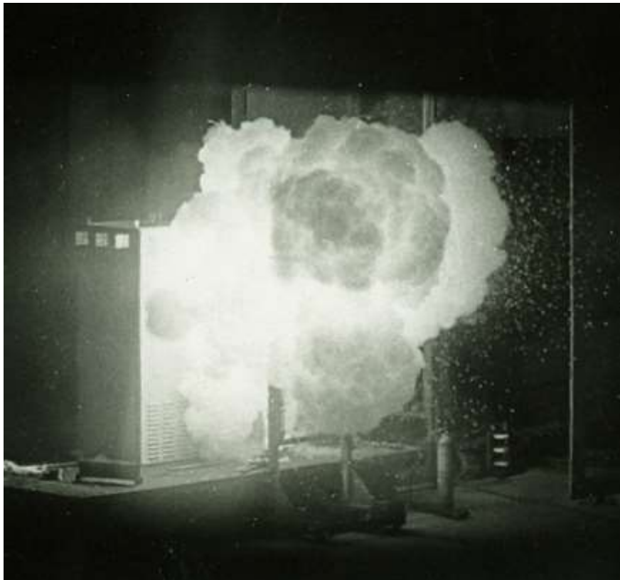
Bild 3:geöffnetes Schaltfeld mit Versuchspuppe während der Belastung mit 25 kA bei 660 V und 500 ms Einwirkzeit
