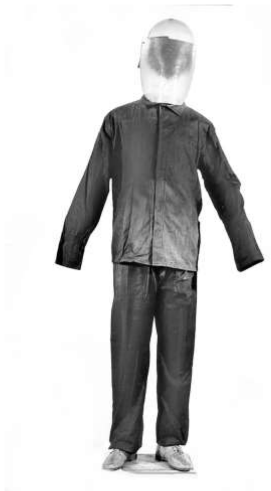
Bild 15: Ausrüstung der Kategorie 1, Belastung mit 400 V, 50 kA, 57 ms, Zündung im Gesichtsbereich und im Bauchbereich
