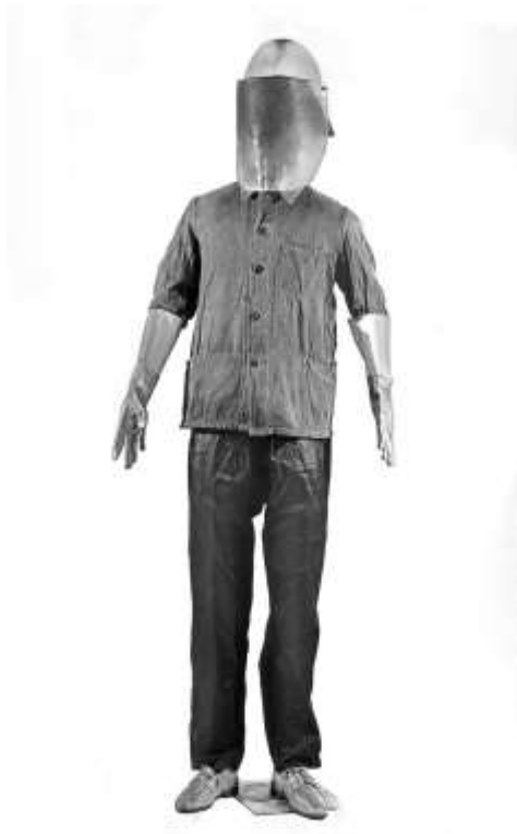
Bild 14: Ausrüstung der Kategorie 1, Belastung mit 730 V, 17,2 kA, 142 ms. Zündung des Lichtbogens im Gesichtsbereich und im Bauchbereich
