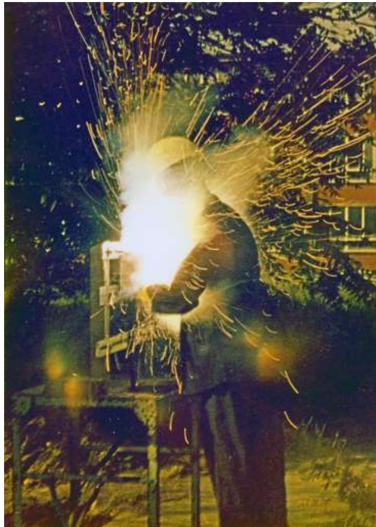
Bild 12: Lichtbogen in einem Hausanschlusskasten mit 380 V, 2 kA, 260 ms
