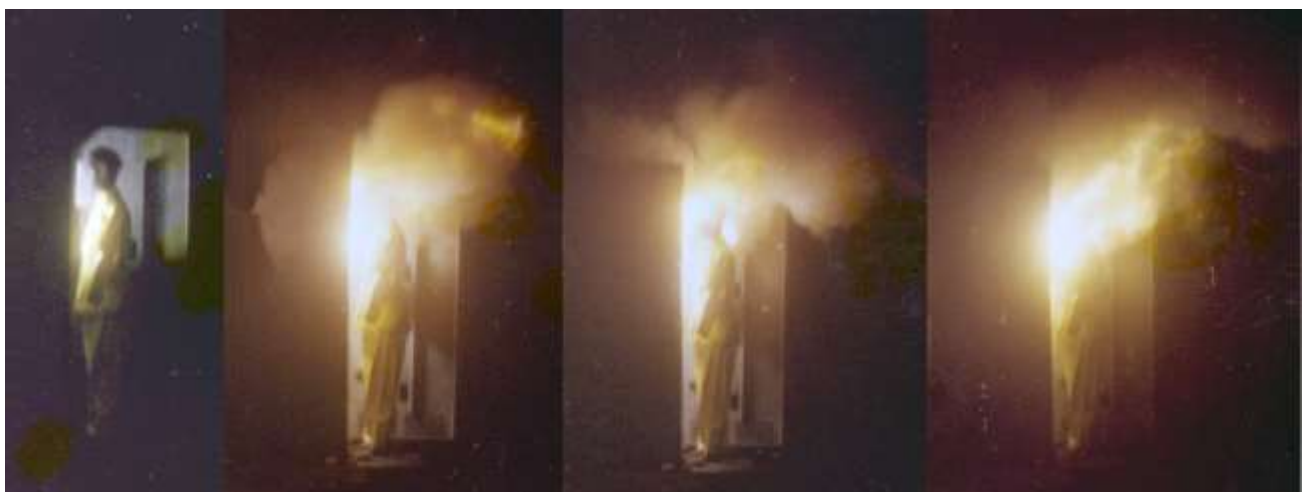
Bild 9: Ausschnitte aus einem Zeitlupenfilm Belastung mit 660 V, 2,1 kA, 2,1 s a = 2ms, b = 700 ms, c = 1,4 s, d = 2,1 s
