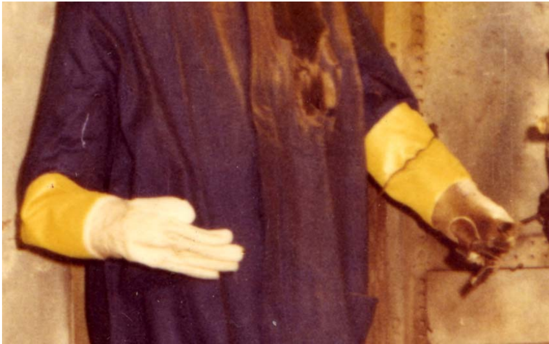
Abb. 3: Lederhandschuhe vor (links) und nach (rechts) der Prüfung für die Kategorie 1 mit 3,5 kA 0,5s
