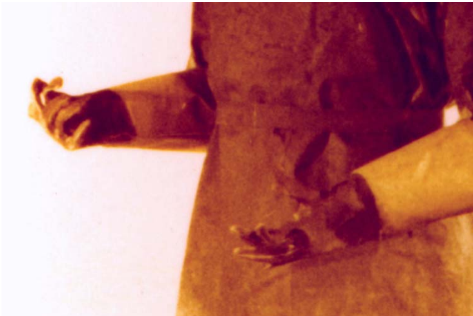
Abb. 4: Lederhandschuhe nach der Prüfung für die Kategorie 2 mit 20 kA, 1,0 s
