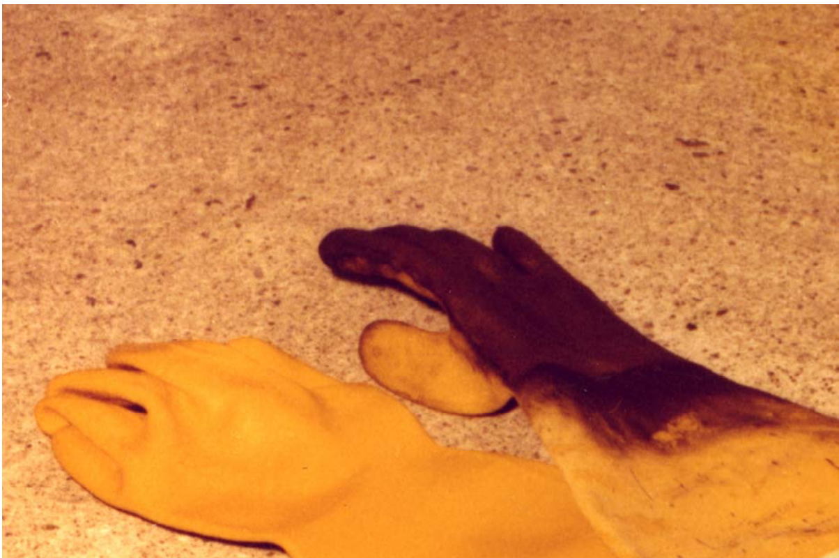
Abb. 5: TRI-Schutzhandschuhe vor und nach der Prüfung mit 20 kA 1s
