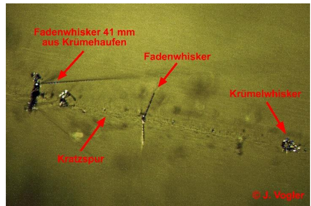
Bild 10 und 11 : Whisker auf verzinnter Aluminiumschiene eines Schaltgerätes
